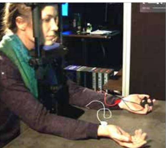
Le capteur d'activité électrodermale (AED) (fixé aux doigts de la participante) mesure l'activité du système sympathique. Les électrodes (ici fixées aux poignets) sont utilisées pour l'enregistrement de l'activité cardiaque (ECG) pour extraire une activité du système parasympathique. Ci dessus les signaux AED et ECG Measuring the galvanic activity (EDA) (sensor attached to the participant's fingers) and heart activity (ECG) (electrodes attached to the wrist) to extract the activity of the parasympathetic and sympathetic system. AED and ECG signals.
